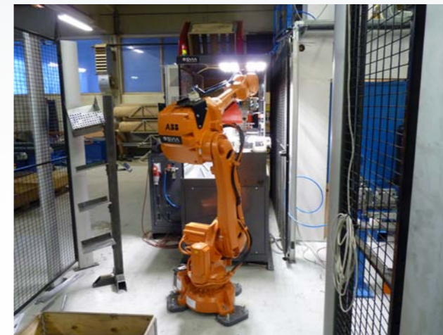
Pick Vision celle for automatisk plukking av deler
